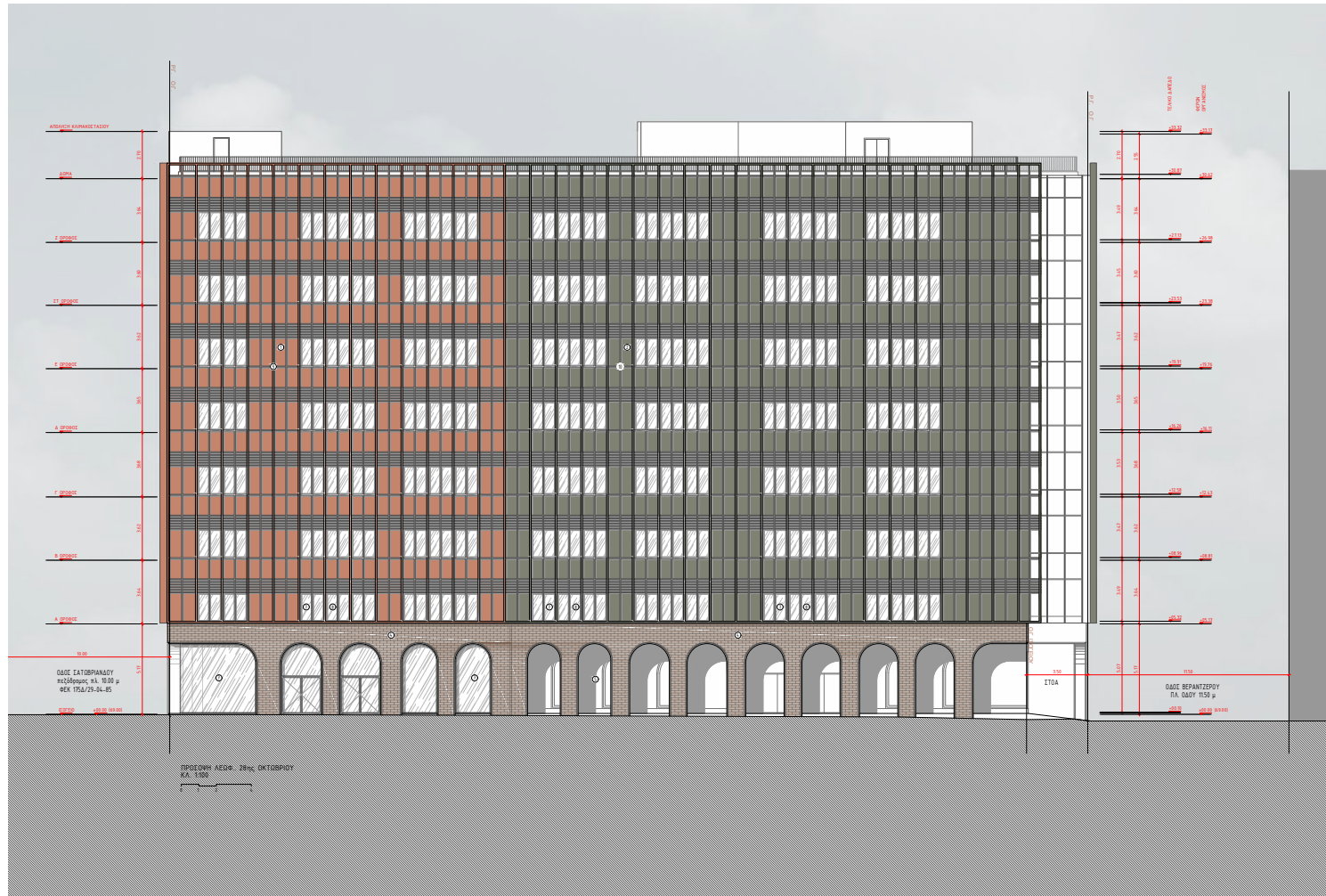
Ανατολική όψη επί της Λεωφ. 28ης Οκτωβρίου. Μια σειρά από αψίδες σε διαφορετικές διαστάσεις, που ακολουθούν τον στατικό κώνο του κτιρίου.
